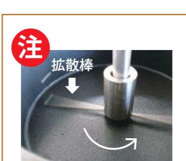
※**3** の作業の際に釜の中の拡散棒が回転しているのを確認して下さい。
