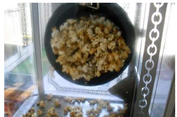
**5** はじける音が小さくなったら、モータースイッチとヒータースイッチをOFFにし、フタを開けすばやくハンドルをもち釜を開けて下さい。
