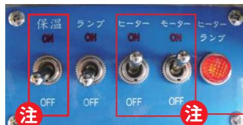
ポップコーンが出来上がったら、必ずヒータースイッチとモータースイッチを切って下さい。長時間空焚きしますと、釜に温度調節器が故障の原因になります。
